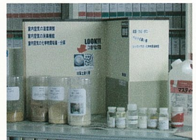
実験室の調湿壁のミニチュアを作成 エコカラット、調湿クロス、珪藻土の塗り壁 手前は珪藻土の原料サンプル等
